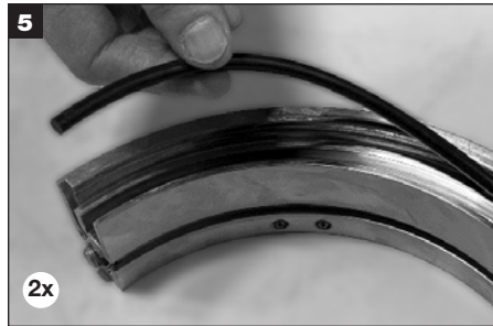
5 Déposez les moitiés de joint torique de la face tournante.
